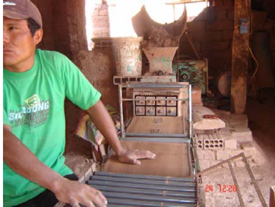
Extrusora de ladrillos en ladrillera de San Jerónimo
